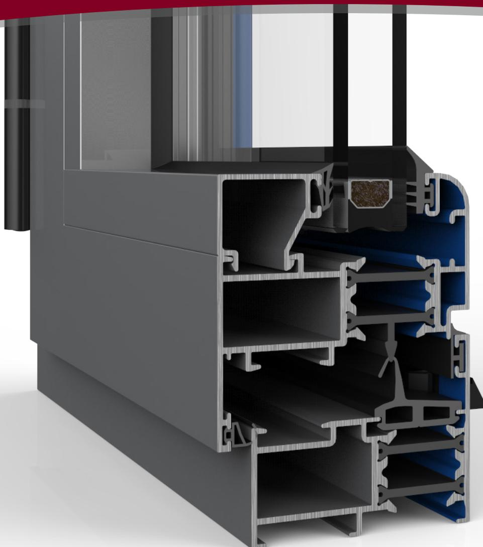
Carpintería practicable de 59mm. Rotura de puente térmico mediante pletinas de poliamida de 24mm, consiguiendo así un valor de transmitancia térmica al marco de hasta  $U_{h,m} = 2,8 \text{ W/m}^2\text{K}$  para doble acristalamiento. De esta forma, podemos conseguir valores de hasta  $U_h = 1,2 \text{ W/m}^2\text{K}$ , según dimensiones y modelo de vidrio instalado.
